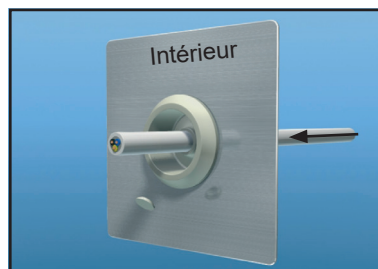
Percer la membrane avec le câble.
